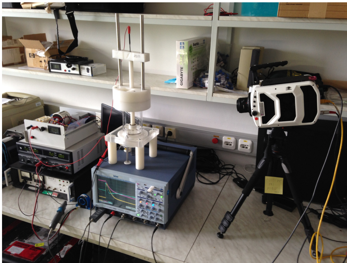
Slika 15: Snemanje razelektritve v sistemu ZEVS s hitro kamero, ki jo proži osciloskop.
