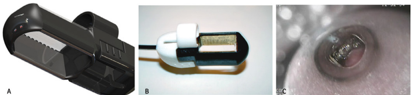
Slika 7: Endoskopske elektrode EndoVe. A) model CAD. B) Slika elektrode. C) Prikaz tarčne spremembe med endoskopskim postopkom.
